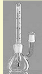
Colocar tapón, Secar y Pesar m_1
