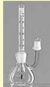
Colocar tapón, Secar y Pesar m_2
