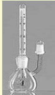
Pesar picnómetro m_{pic}
