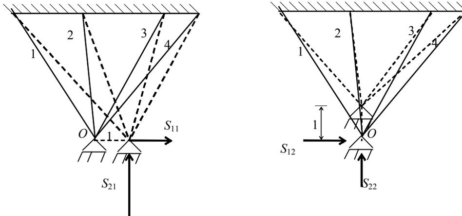
Figura 4 Coeficientes de rigidez de la armadura para cada uno de los grados de libertad.
