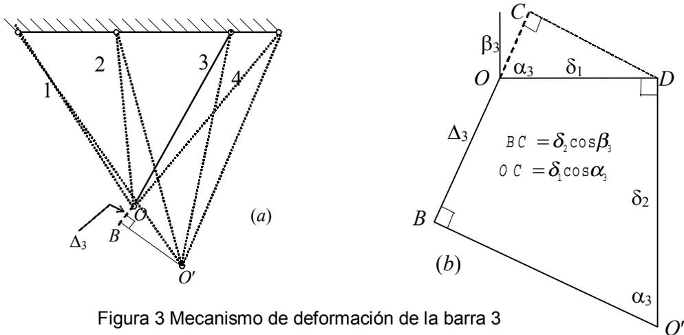
Figura 3 Mecanismo de deformación de la barra 3
