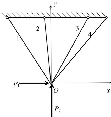
Figura 1 Problema de Navier: Sistema estructural con 4 barras
