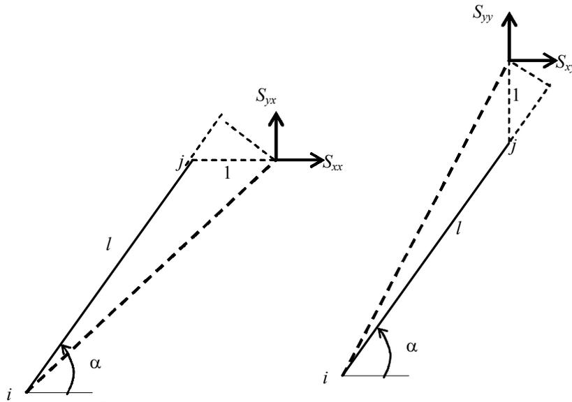
Figura 5 Cálculo de los coeficientes de rigidez
