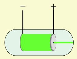
Cuando se perfora el electrodo positivo (ánodo), se observa como pasa a través del orificio un haz luminoso.
