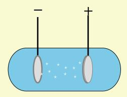
Con gas a presión normal se observa poca conductividad, pero aplicando una diferencia de potencial elevada también se aprecian descargas eléctricas.
