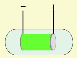
Con gas a baja presión, se observa un haz luminoso entre los electrodos y la conductividad aumenta considerablemente. El haz se asoció al desprendimiento de partículas del electrodo negativo (cátodo), posteriormente a dichas partículas se les dio el nombre de electrones.
