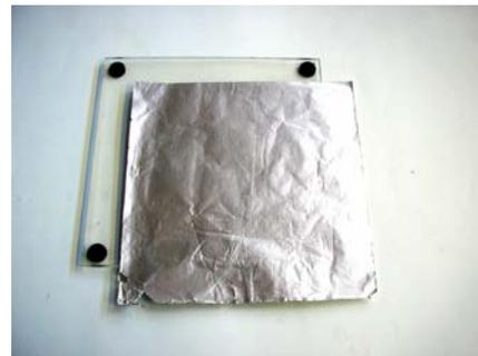
Debemos asegurarnos que en las orillas del capacitor no exista contacto entre las placas conductoras porque si esto sucede deja de ser un capacitor.
