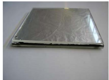
Partiendo de este valor se colocarán diferentes pesos conocidos, como pueden ser: monedas de \$10, o elementos que tengan un peso constante para poder tomar una lista de datos y encontrar la relación entre la variación de la capacitancia en función del peso colocado sobre el capacitor.
