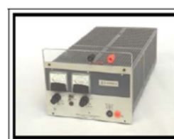
Foto 8. Fuente de poder de 0-20 [V] 0-10 [A] de cd.
