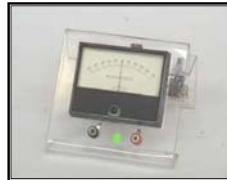
Foto 3. Micro-amperímetro de \pm 50 [ \mu\text{A} ] y cero central.
