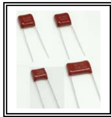
Foto 6. Capacitores de poliéster (proporcionados por los alumnos).
