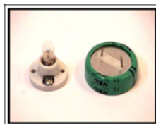
Foto 6. Foco de 6.3 [V] y capacitor de 1[F].
