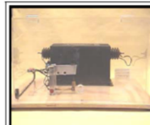
Foto 7. Caja para prueba de rigidez dieléctrica.
