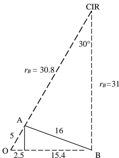
18. La barra  $AB$  del mecanismo de cuatro articulaciones de la figura gira con una velocidad angular  $\omega_1$  de 9 rad/s en sentido antihorario. Determine las velocidades angulares  $\omega_2$  y  $\omega_3$  de las barras  $BC$  y  $CD$ , en la posición mostrada.
