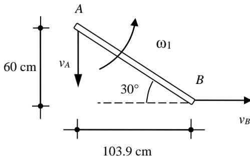
12. En la posición mostrada, la manivela  $OA$  tiene una rapidez angular de  $10 \text{ rad/s}$  en sentido anti-horario. Calcule la rapidez angular de la biela  $AB$  y la velocidad lineal del émbolo  $B$ .
